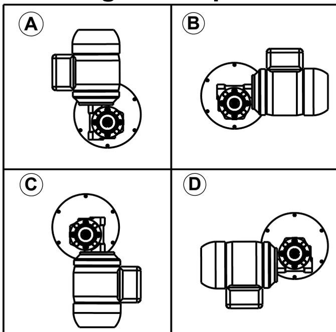
Optando por uma das montagens de motor ao lado, o conjunto já será fornecido de acordo. Porém, se necessário, a mesma pode ser alterada entre qualquer uma das posições.
