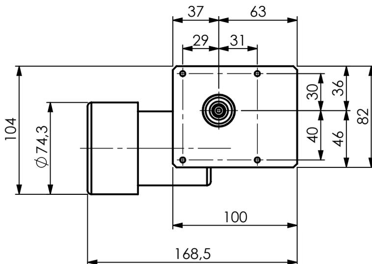
Sistema de segurança anti-travamentos de proteção, composto por mecanismo de fricção limitador de torque.
